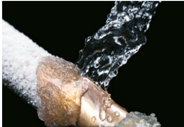
Abb.: Wasserrohr mit Leckage
